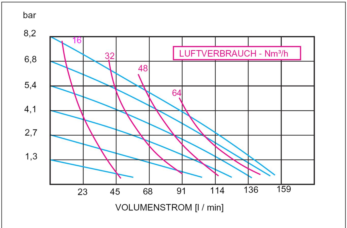
**Abb. 1** : Druck-Volumenkurve Baugröße 1" (gültig für Wasser bei 20°C)
