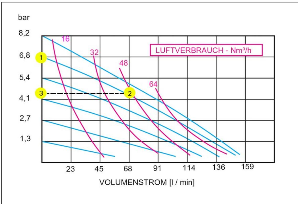
Abb. 2 : Druck-Volumenkurve mit Beispieldaten (gültig für Wasser bei 20°C)
