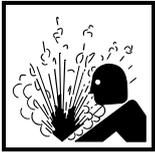
DIE INSTALLIERTE PUMPE IST TEIL EINES DRUCKLUFTSYSTEMS UND STEHT GEBEENENFALLS UNTER SEHR HOHEM DRUCK, DER ZU TÖDLICHEN ODER SCHWEREN VERLETZUNGEN FÜHREN KANN. STELLEN SIE UNBEDINGT SICHER, DASS DIE PUMPE **VOR** WARTUNGS- ODER REPARATURARBEITEN VON DER DRUCKLUFTVERSORGUNG GETRENNT WIRD.
