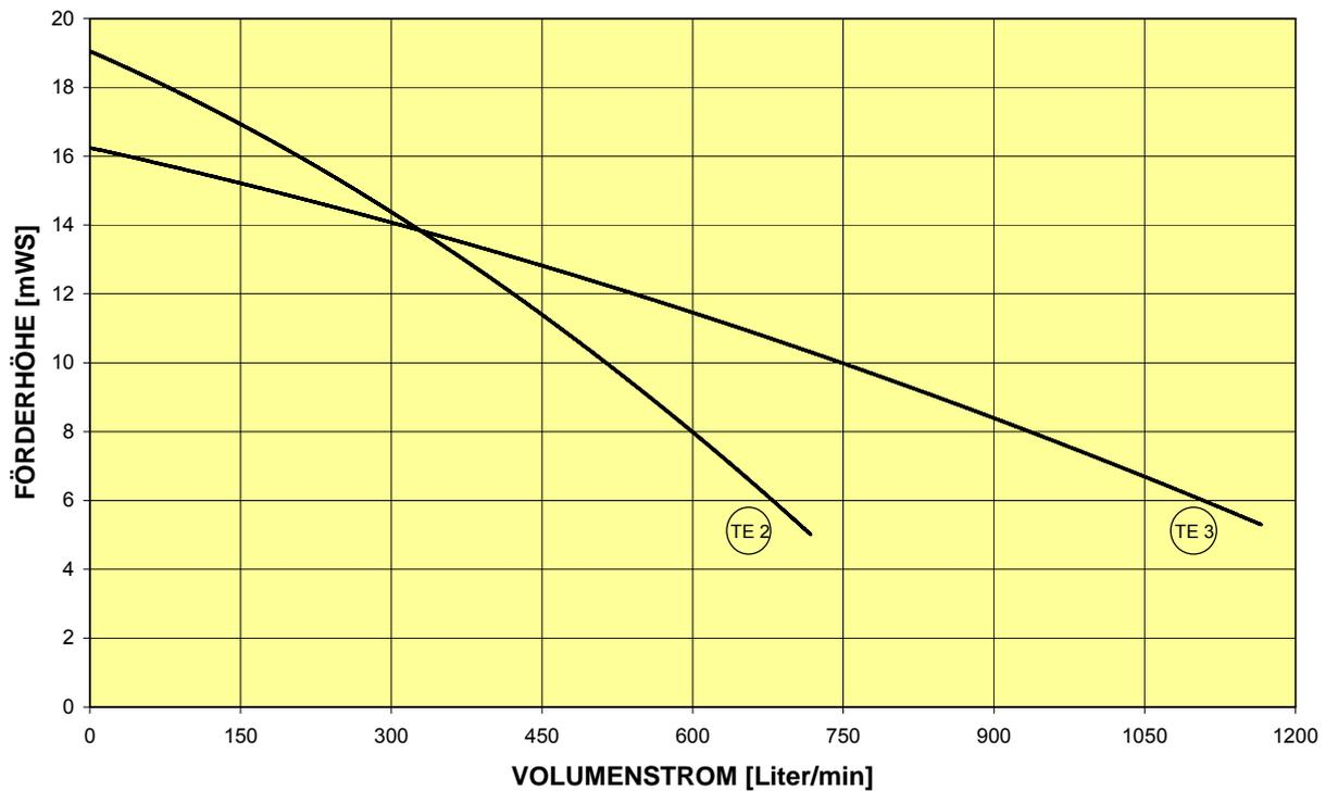
**Abb. 1** : Druck-Volumenkurve TE2/TE3 (gültig für Wasser bei 20°C)
